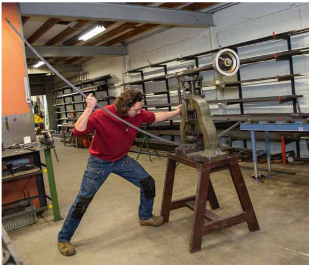
Lange ijzeren staven worden door Wout precies op maat gebogen.
